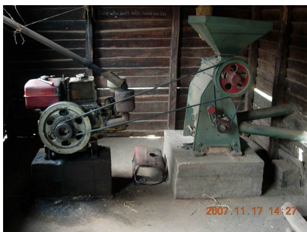
Image 12 : Moteur diesel stationnaire
